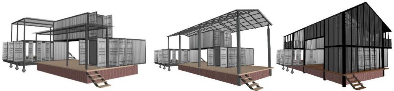
รูปที่ 2 แบบร่างหลังจากการเปลี่ยนรูปแบบมาใช้ตู้คอนเทนเนอร์ขนาด 20 ฟุต การศึกษารูปแบบของการสร้างหลังคาและรูปด้านใน หลากหลายรูปแบบโครงสร้าง
