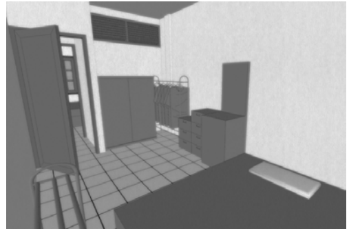
รูปที่ 8 ลักษณะการเพิ่มช่องแสงและช่องระบายอากาศห้องนอนด้านหลัง
