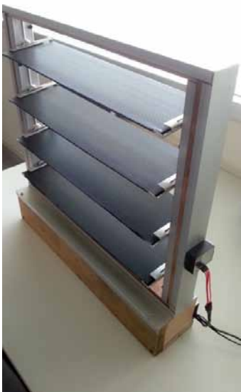
รูปที่ 2 โครงสร้างต้นแบบของแผงกันแดดแบบปรับได้
