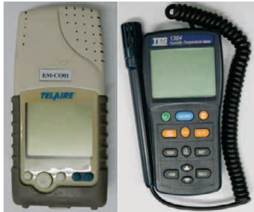
รูปที่ 4 เครื่องวัดคาร์บอนไดออกไซด์ (TELAIRE 7001) และเครื่องวัดอุณหภูมิและความชื้นสัมพัทธ์ (TES-1364)
