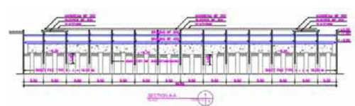
รูปที่ 4 แบบ Section ของระบบป้องกันดินพังแบบเข็มพืดเหล็ก
