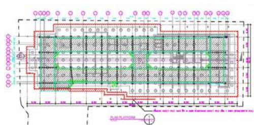
รูปที่ 3 แบบ Plan ของระบบป้องกันดินพังแบบเข็มพืดเหล็ก
